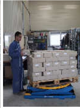
Selbsttätiger Palettenpositionierer Funktion ohne weiteren Energieeintrag
