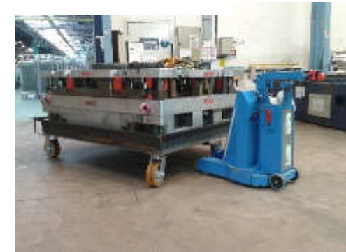
Autonome elektrische Schlepper bis zu 15 Tonnen Last Einfaches Lenken und Verfahren
